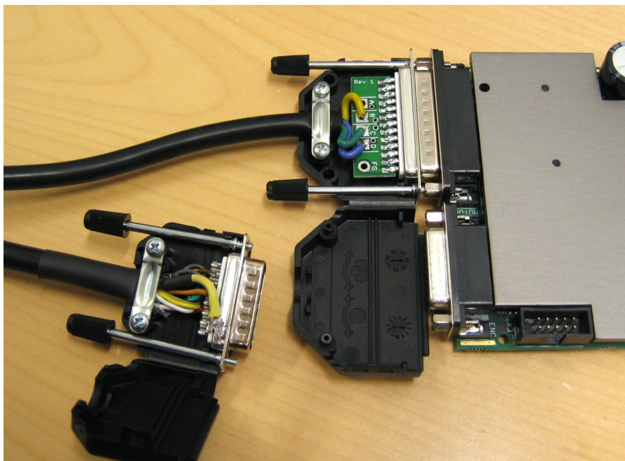
图3：有线编码器 & 马达d-sub连接器（盖打开的）
